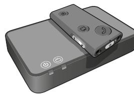
2. Legen Sie das SoundGate 3 auf den Telefon-Adapter 2 – das Pairing kann bis zu 60 Sekunden dauern. Das Pairing ist abgeschlossen, wenn die Statusanzeige des Telefon-Adapters 2 permanent blau leuchtet.
