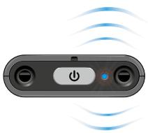
1. Halten Sie den Ein-/Ausshalter des SoundGate 3 für 5–6 Sekunden gedrückt, bis die LED-Anzeige schnell blau blinkt.
