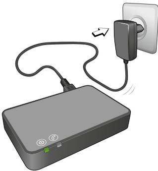
1. Stellen Sie sicher, dass der Telefon-Adapter 2 mit dem in der Verpackung enthaltenen Netzteil (Mini-USB) an eine Steckdose angeschlossen wird. Die Statusanzeige leuchtet grün, sobald das Gerät mit dem Stromnetz verbunden ist.
