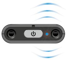
1. Halten Sie den Ein-/Ausschalter des SoundGate 3 für 5–6 Sekunden gedrückt, bis die LED-Anzeige schnell blau blinkt.
