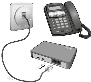
3. Stecken Sie das Telefonkabel aus dem Festnetztelefon in die "IN" Buchse des Telefon-Adapters 2.
