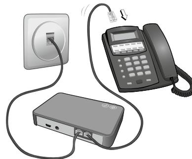
4. Stecken Sie das eine Ende des mitgelieferten Telefonkabels in die "OUT" Buchse des Telefon-Adapters 2.
