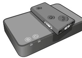
2. Legen Sie das SoundGate 3 auf den TV-Adapter 2 – das Pairing kann bis zu 60 Sekunden dauern. Das Pairing ist abgeschlossen, wenn die Statusanzeige des TV-Adapters 2 blau wird und anschliessend konstant orange leuchtet.
